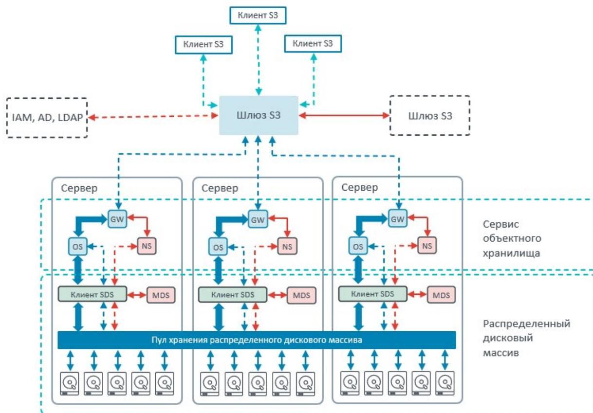
Рисунок 2. Архитектура Машины хранения данных (Схема внутренней коммутации)
