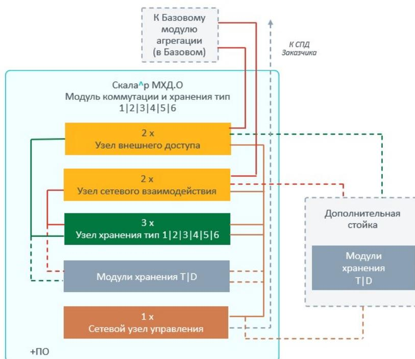
Рисунок 7. Схема модуля коммутации и хранения
