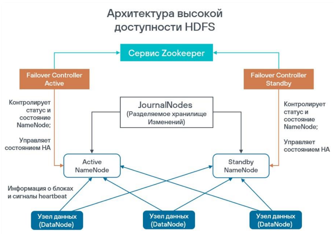
Рис. 2 Схема архитектуры высокой доступности HDFS
