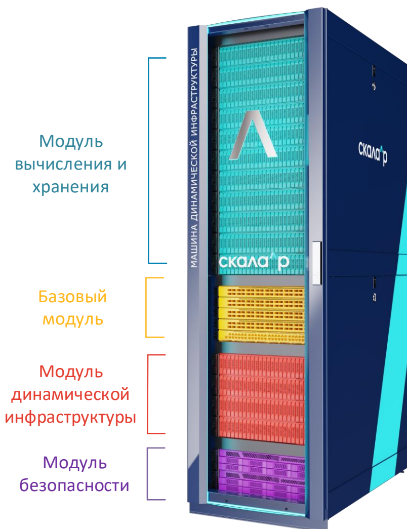
Рисунок 1. Машина динамической инфраструктуры Скала^р МДИ.О
