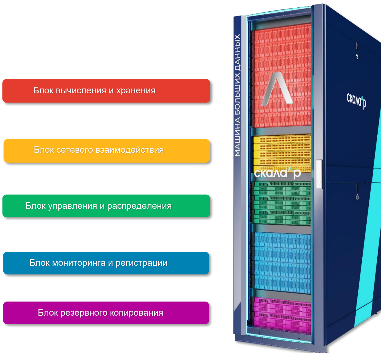
Рис. 1 Блоки в составе Машины больших данных Скала^р МБД.Г
