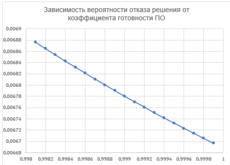
Рисунок 23. График зависимости вероятности отказа решения от коэффициента готовности программного обеспечения
