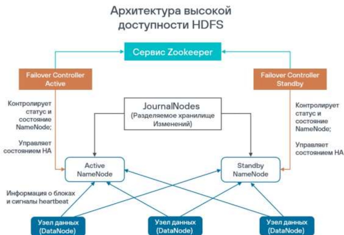
Рис. 2 Схема архитектуры высокой доступности HDFS
