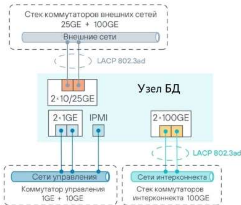
Рисунок 4. Схема сетевого взаимодействия вычислительного узла
