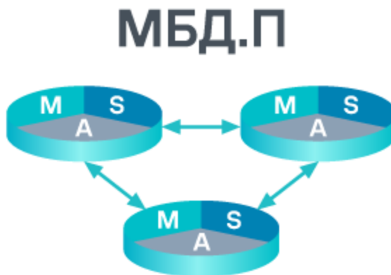
Рисунок 15. «Шахматное» размещение БД по узлам кластера
