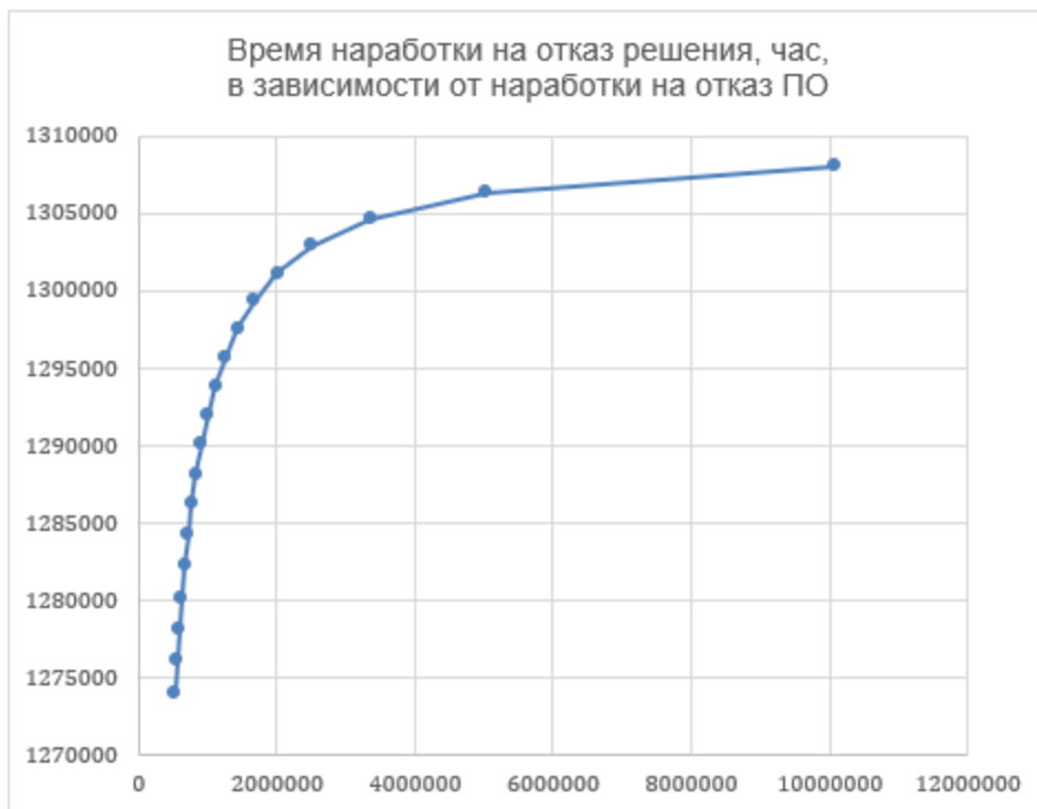
Рисунок 22. График зависимости времени наработки на отказ решения от времени наработки на отказ комплекта программного обеспечения
