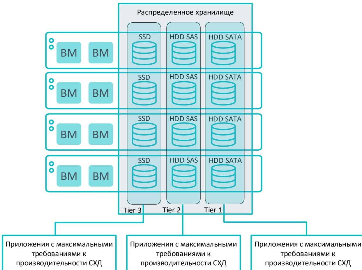
Рисунок 1. Типовая схема комплекса Скала^р МВ.С
